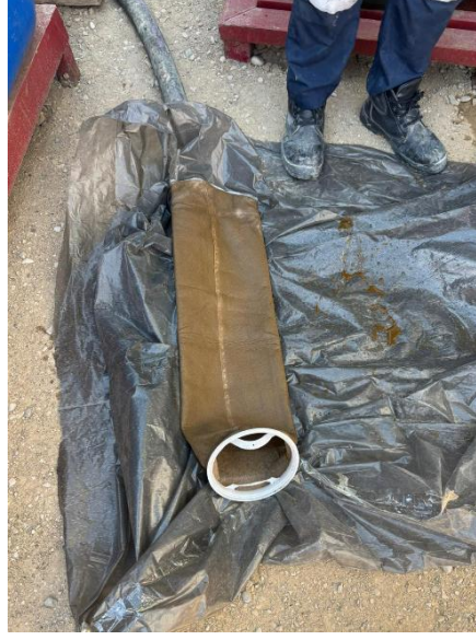
Şekil 1 — Filtreli devre sirkülasyonu sonrası kirli filtre torbası. Partikül yükü filtre kapasitesini aşmıştır.
