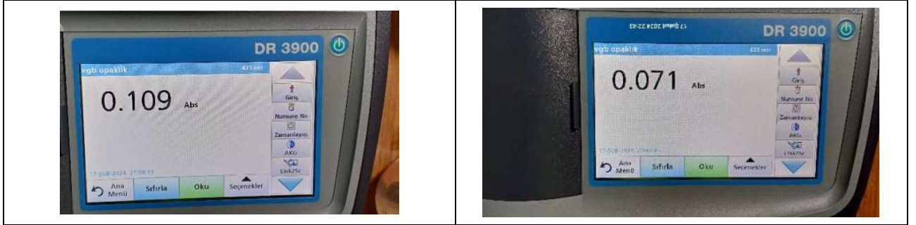
Şekil 6 — VGB opaklık testi: 0,109 Abs ve 0,071 Abs — her ikisi de < 0,2 hedefinin altındadır.
